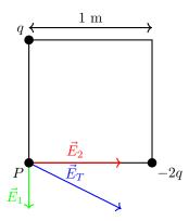
Para determinar el campo eléctrico en el punto P debido a las cargas q y -2q, utilizamos la Ley de Coulomb y el principio de superposición de campos eléctricos.
